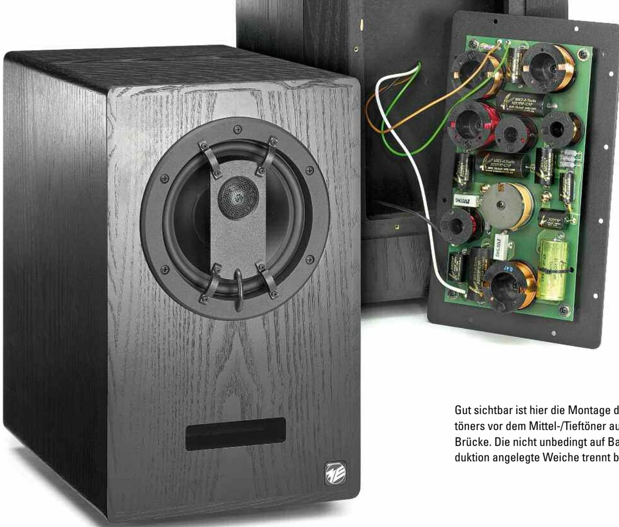
Gut sichtbar ist hier die Montage des Hochtöners vor dem Mittel-/Tieftöner auf einer Art Brücke. Die nicht unbedingt auf Bauteilreduktion angelegte Weiche trennt bei 2500 Hz
